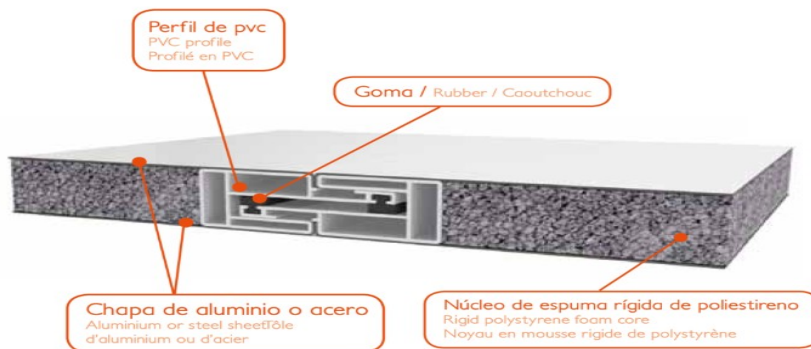
Detalle grueso 32 mm. Detail of 32 mm thickness Détail de l'épaisseur de 32 mm
